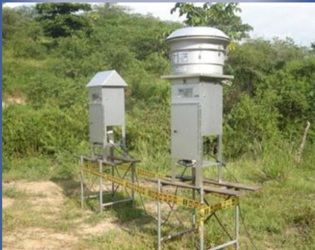
Foto No 5. Equipo de Medición de calidad de aire Hi-Vol, Botadero La Esmeralda Municipio de Barrancabermeja
